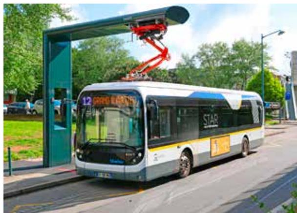
*Terminus de la ligne - pantographe inversé installé pour rechargement ponctuel des 8 batteries, 4 sur le toit et 4 à l'arrière du bus.»*
