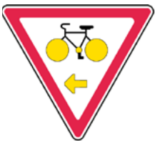
◀ Panonceau M12 de tourne-à-gauche
